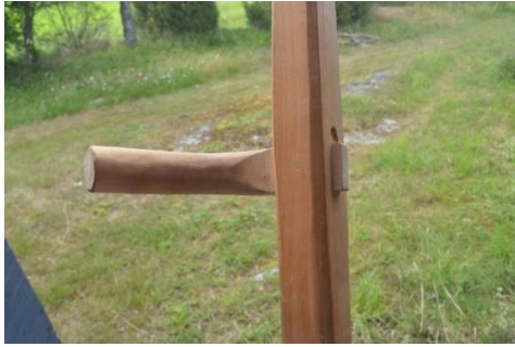
Bild 7 Knagge monterad med genomgående pinne
