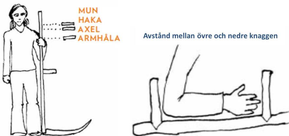
Bild 5 Beräkning orvets längd och knaggarnas placering. Bilderna från Liehandboken.
