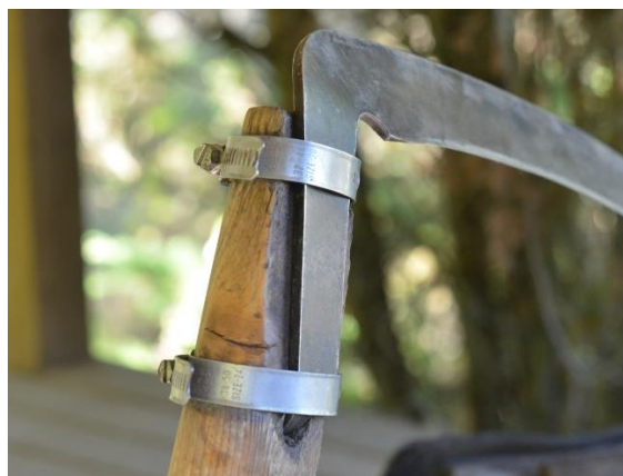
Bild 14 Slangklämmor används för att fästa lien.
