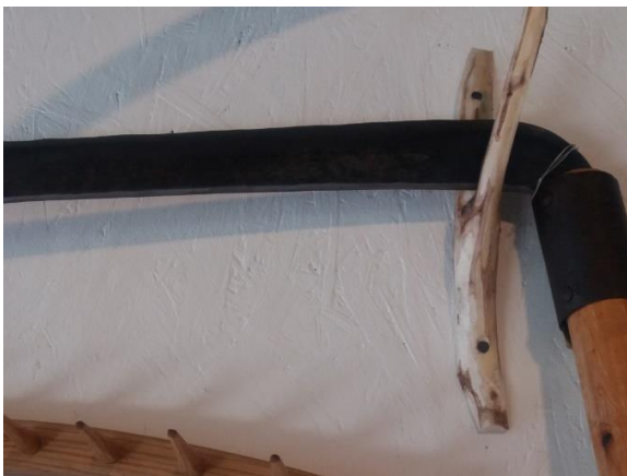
Bild 11 En hylsa av järn används för infästning liebladet.
