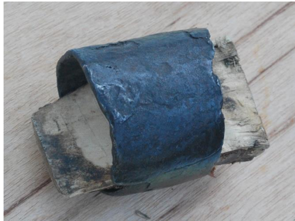
Bild 12 Smidd och väld hylsa av järn
