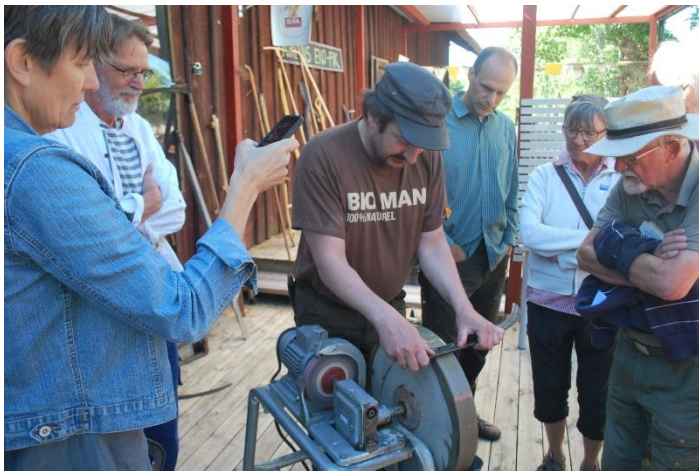
Bild 3 Mattias Helje visar hur det färdiga liebladet slipas.
