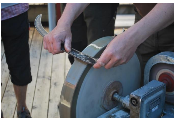
Bild 4 När vattnet bromsas upp av liebladet blir eggen för trubbig.
