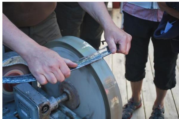
Bild 5 När vattnet rinner i en tunn ström över bladet är vinkeln rätt.
