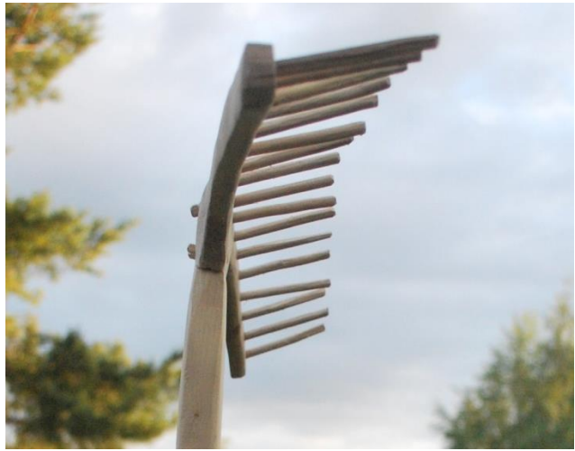
Bild 18 Räfsa svängd i båda riktningarna samt "överbett"
