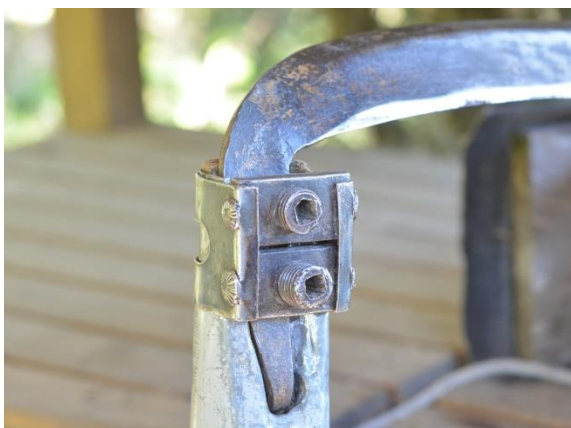
Bild 13 Liering. Nedre delen av orvet förstärkt med plåt.
